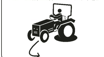
穴に後輪が落ちて制御不能
